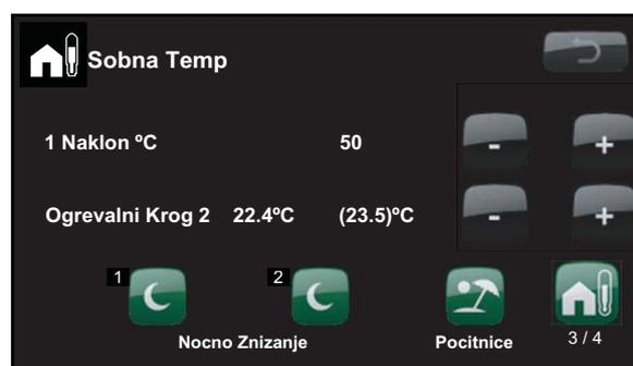
Zgornji meni prikazuje ogrevalni krog 1, ki deluje brez sobnega senzorja in ogrevalni krog 2, ki deluje s sobnim senzorjem. Kadar je zunanja temperatura nižja od 0 stopinj Celzija, bo prikazovalnik izpisal vrednost parametra Naklon. Kadar je zunanja temperatura višja od 0 stopinj Celzija, bo prikazovalnik izpisal vrednost parametra Zamik.
