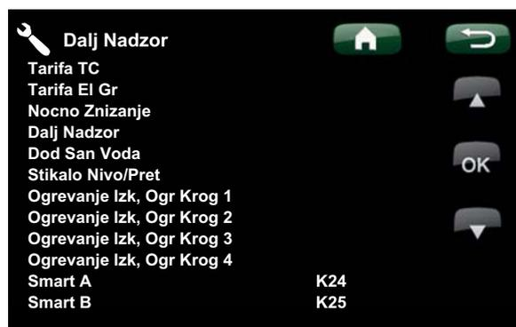
V navedenem primeru je parametru Smart A dodeljen kontakt K24, parametru Smart B pa kontakt K25.
