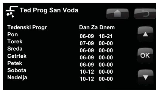
V ponedeljek zjutraj ob 6 uri sistem prične ogrevati dodatne količine sanitarne vode vse do 9 ure, ko se temperatura spet spusti na normalen nivo. Naslednje obdobje po- višanja je predvideno med 18 in 21 uro zvečer.
