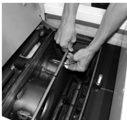
Sl. 68 Odstranite krilno matico na okviru ventilatorja
