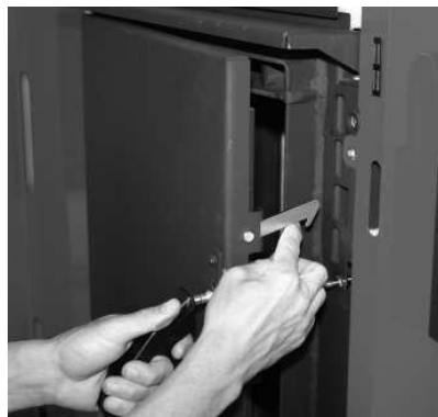
Sl. 51 Dvignite zaporni kavelj na vratih polnilne komore
