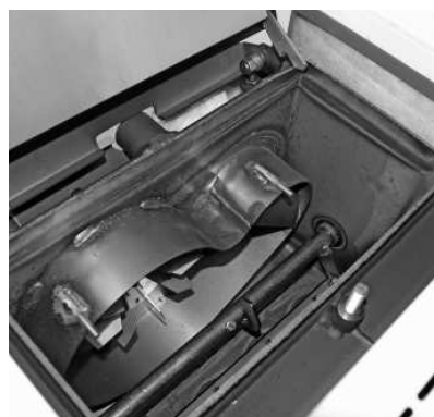
Sl. 69 Očistite okvir in kolo ventilatorja
