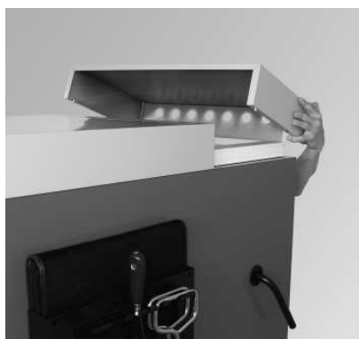
Sl. 66 Odstranite pokrov kotla
