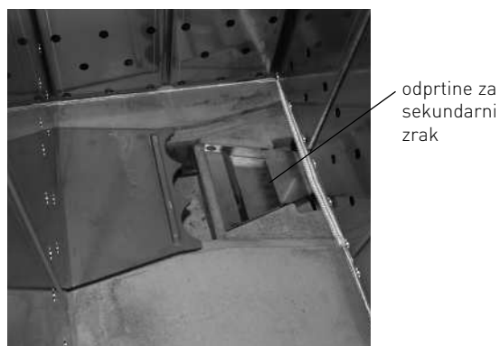
Sl. 72 Odmaknite zgorevalni plošči in preverite odprtine za sekundarni zrak.
