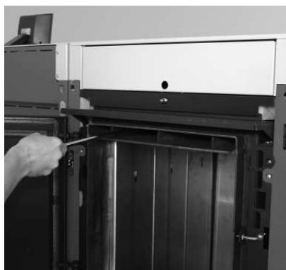
Sl. 65 Očistite dimovod
