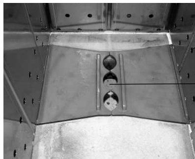
Sl. 53 Polnilna komora, luknje v viseči pločevini, odprtina za izgorevanje
