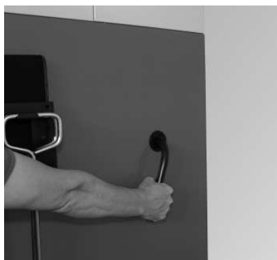
Sl. 61 5-10 x zasučite ročico za čiščenje kurilnih površin
