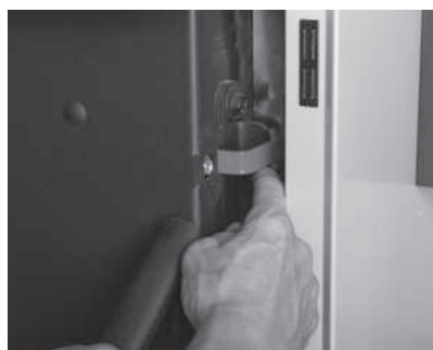
Sl. 51 Dvignite zaporni kavelj na vratih polnilne komore
