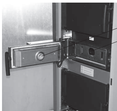
Sl. 62 Preverite odprtini za vžig
