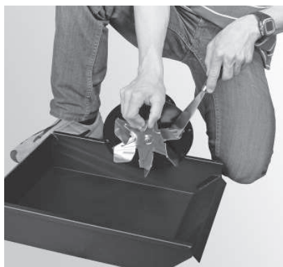
Sl. 68 Očistite ventilator
