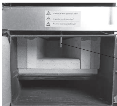
Sl. 72 Očistite tipalo termonadzora
