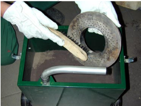
Slika 23: Očistiti gorilni krožnik
