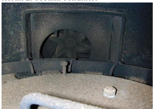
Slika 19: Očistiti sesalni ventilator
