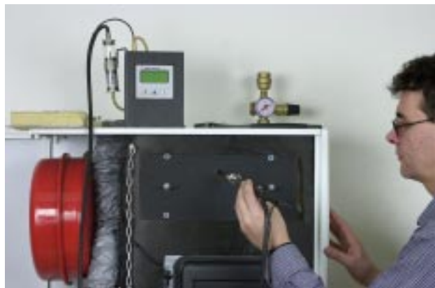
2. Na sprednji strani kotla v čistilnih vratcih je pripravljena odprtina za meritve, ki je različna v kotlu ali 2D od kolena.
