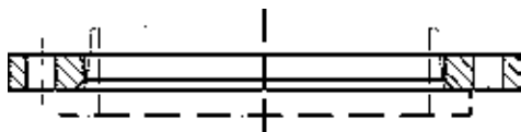
Tipo / type 04 Flangia a piastra mobile con colletto a saldare su collare Loose plate flange with weld-neck collar
