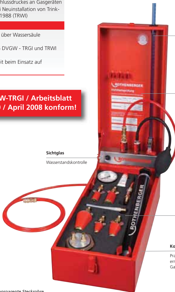
Transparente Steckrohre mit doppelter O-Ring-Abdichtung
