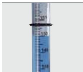
Prüfskala bis 150 mbar auf transparentem Verlängerungssteckrohr
