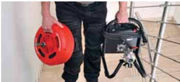
Spiraltrommel zum Transport abnehmbar (keine einseitige Belastung)
