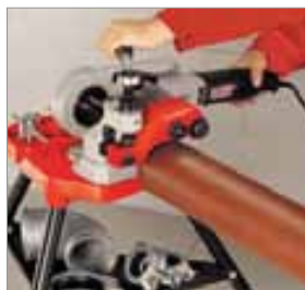
Einsatz mit Rollnutgerät ROGROOVER
