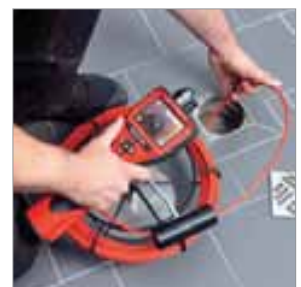
Inspektion von Bodenabläufen
