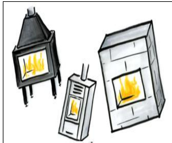
Slika 60; Kamin in kaminska peč na drva s kuriščem na pregorevanje (Vir: www.richtigheizen.at )
