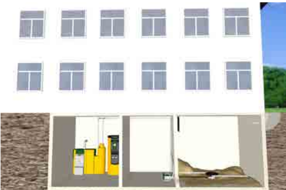
Ogrevanje v kletnih prostorih zgradbe KWB Pelletfire Plus z mešalnim diskom Plus za pelete s sesalno tehniko
