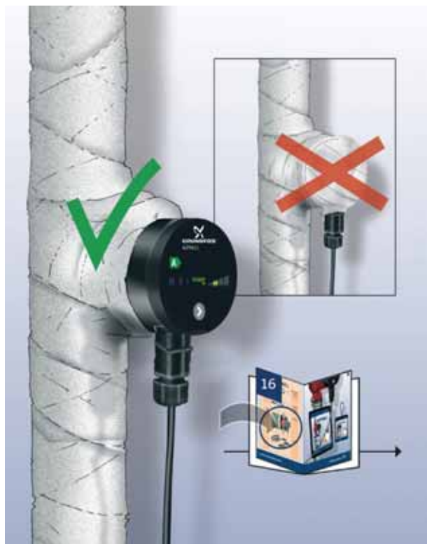
Slika 5 Izolacija ohišja črpalke
